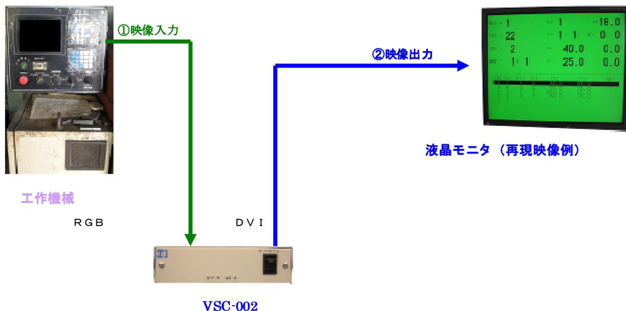
①工作機械と VSC-002 を変換ケーブルにて接続してください。
